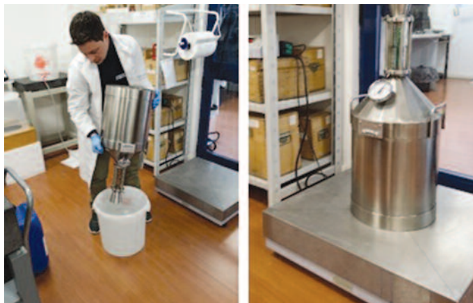
Figura 6 – Tarature dei serbatoi campione Fase di preparazione (lavaggio) alla taratura LAT del serbatoio campione Determinazione del volume del serbatoio mediante metodo gravimetrico
